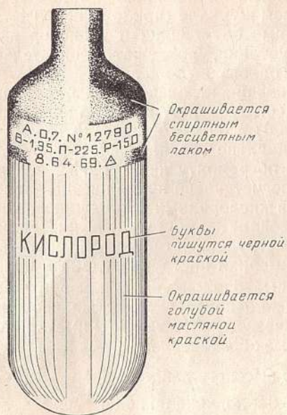
Рис. 3. Нанесение обозначений на кислородный баллончик.
