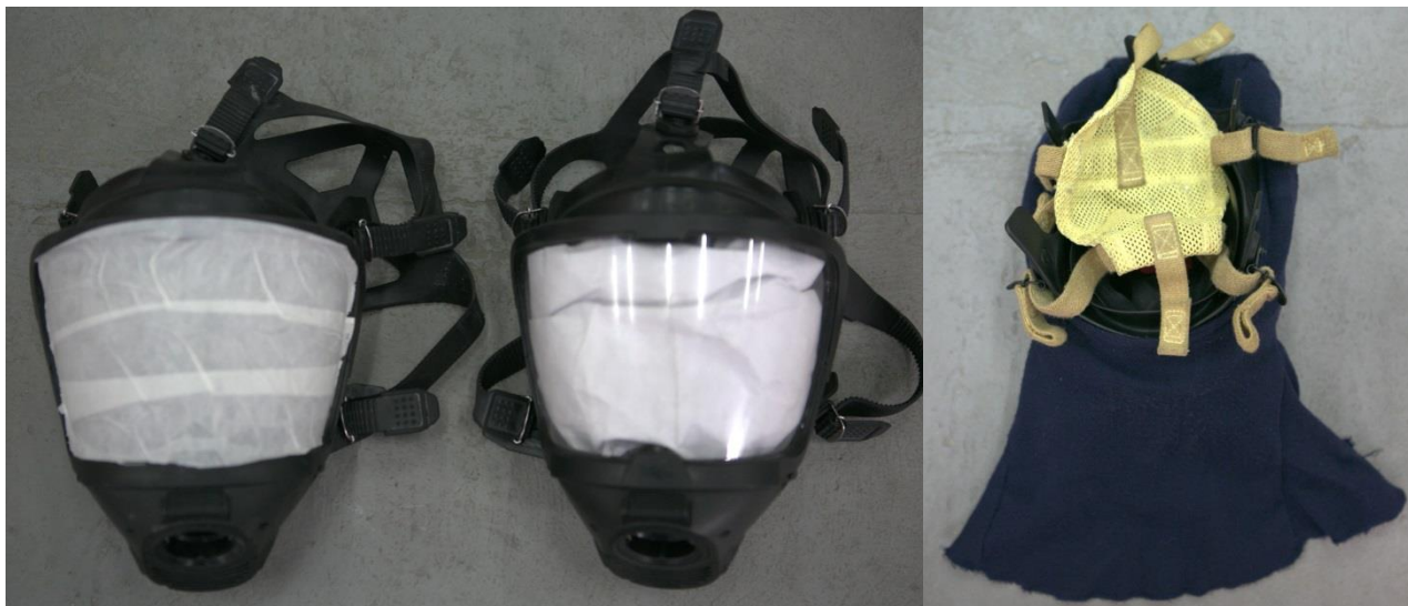
Рисунок 11 – Варианты закрытия обзора на панорамных масках ДАСВ (при помощи бумажного скотча, бумаги и подшлемника, перевернутого наоборот)
