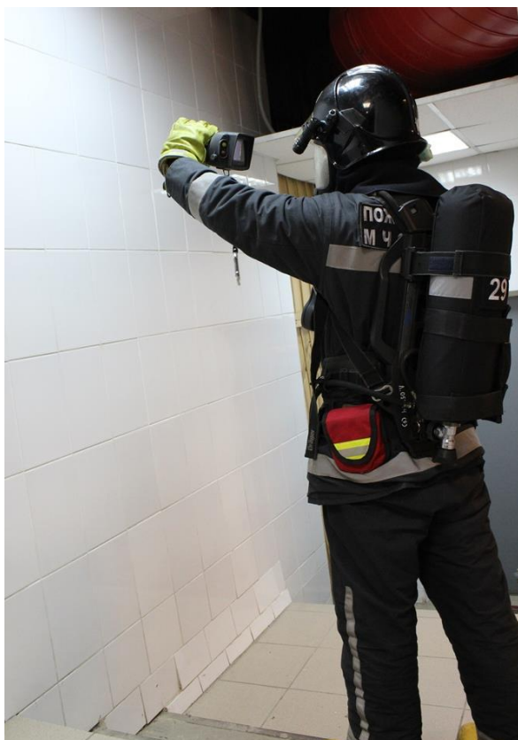
Рисунок 91. Определение скрытого горения при помощи тепловизора
