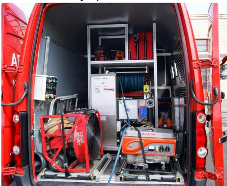
Рисунок 30. Размещение установки пожаротушения в салоне автомобиля
