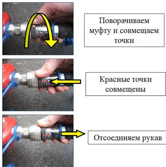
Рисунок 15. Порядок разъединения ствола и рукава высокого давления
