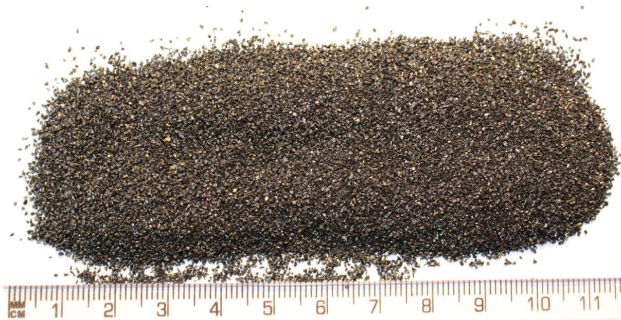
Рисунок 2. Абразивный материал, применяемый для резки конструкций
