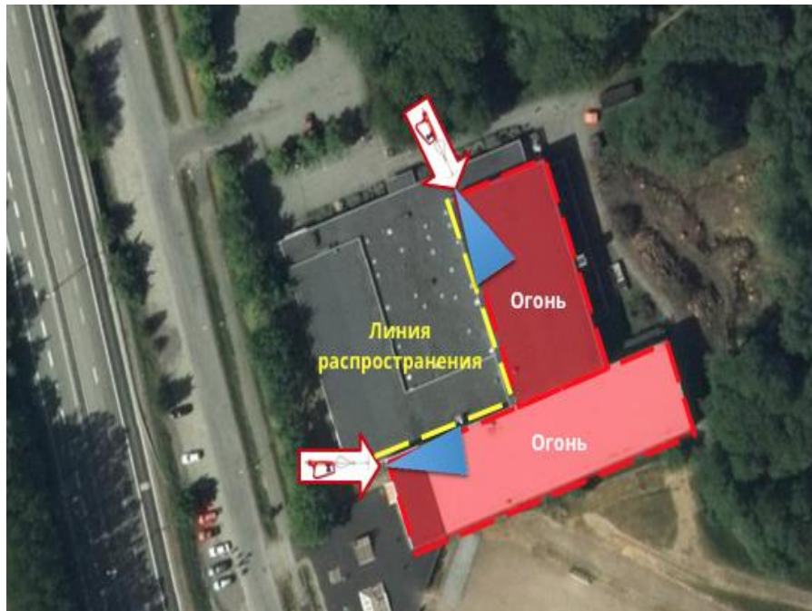
Рисунок 89. Ввод стволов установки на пути распространения огня
