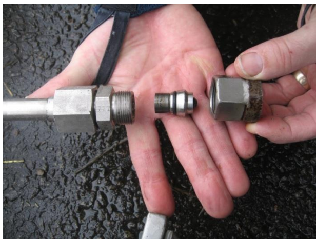
Рисунок 105. Разборка и прочистка распыляющей форсунки
