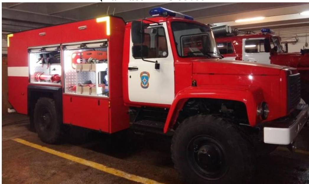
Рисунок 27. Пожарно-спасательный автомобиль с установкой «Кобра» на шасси ГАЗ-33088
