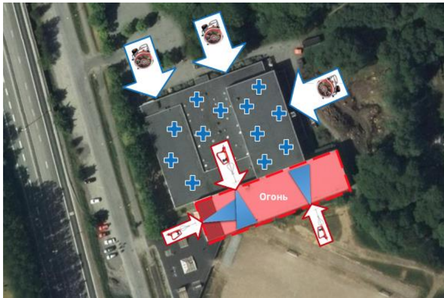
Рисунок 88. Применение установок для тушения пожара в складском здании
