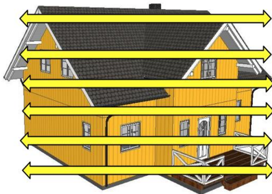
Рисунок 61. Направления сканирования здания тепловизором
