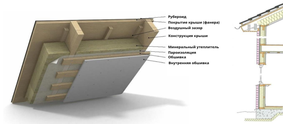
Рисунок 81. Пример конструкции бесчердачного покрытия
