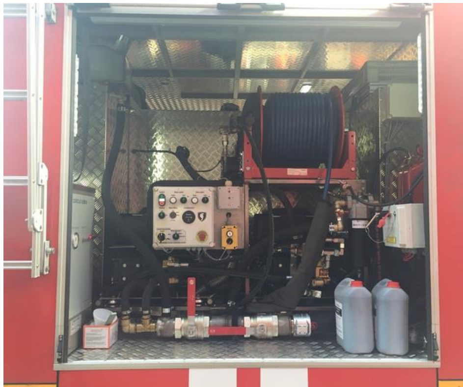
Рисунок 26. Отсек с размещением установки пожаротушения
