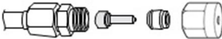
Рисунок 11. Сборка элементов распылительной форсунки
