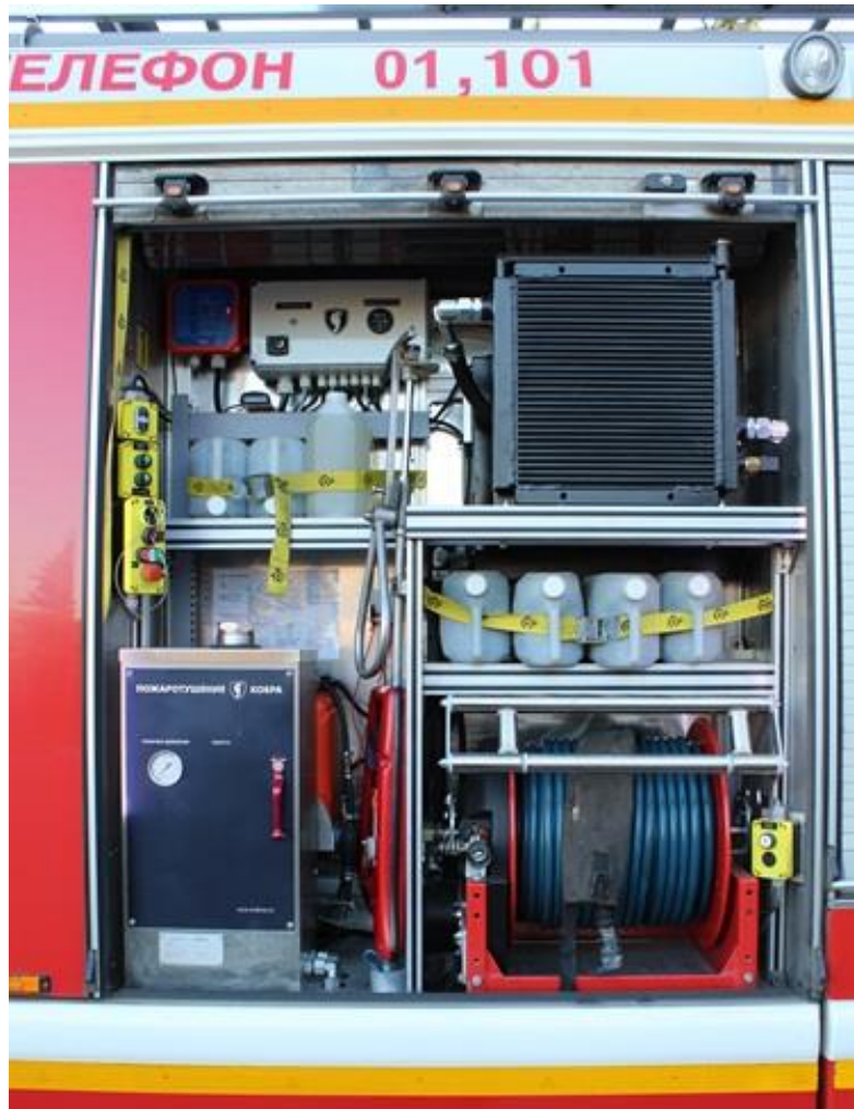
Рисунок 21. Размещение установки пожаротушения в отсеке АЦ-3,2-40/4
