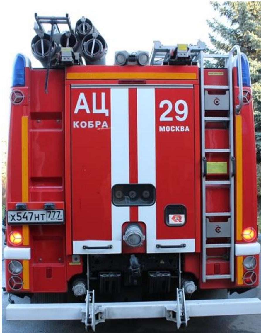
Рисунок 32. Обозначение автомобилей, оборудованных установками пожаротушения с возможностями гидроабразивной резки на примере системы «Кобра»
