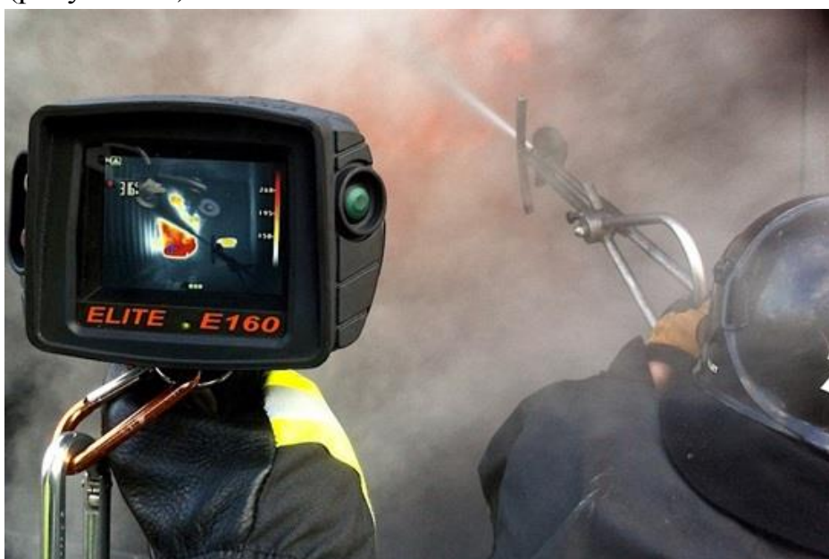
Рисунок 62. Сканирование горящего объекта тепловизором и подача ствола установки на тушение пожара
