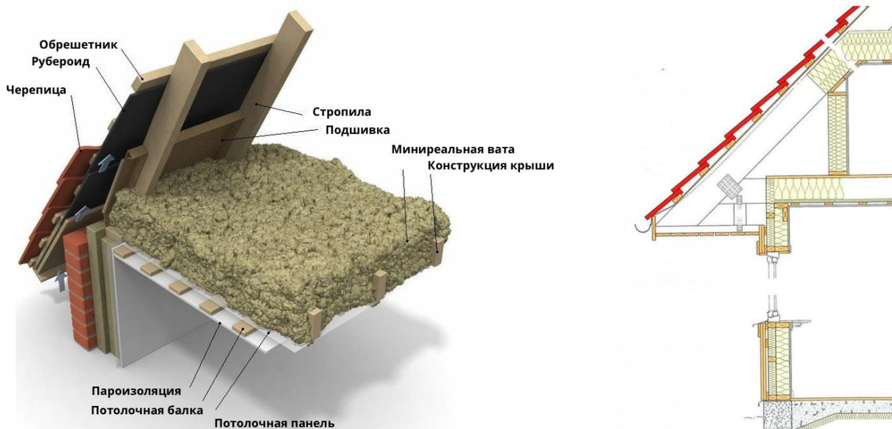
Рисунок 77. Пример конструкции потолка при наличии чердачного помещения
