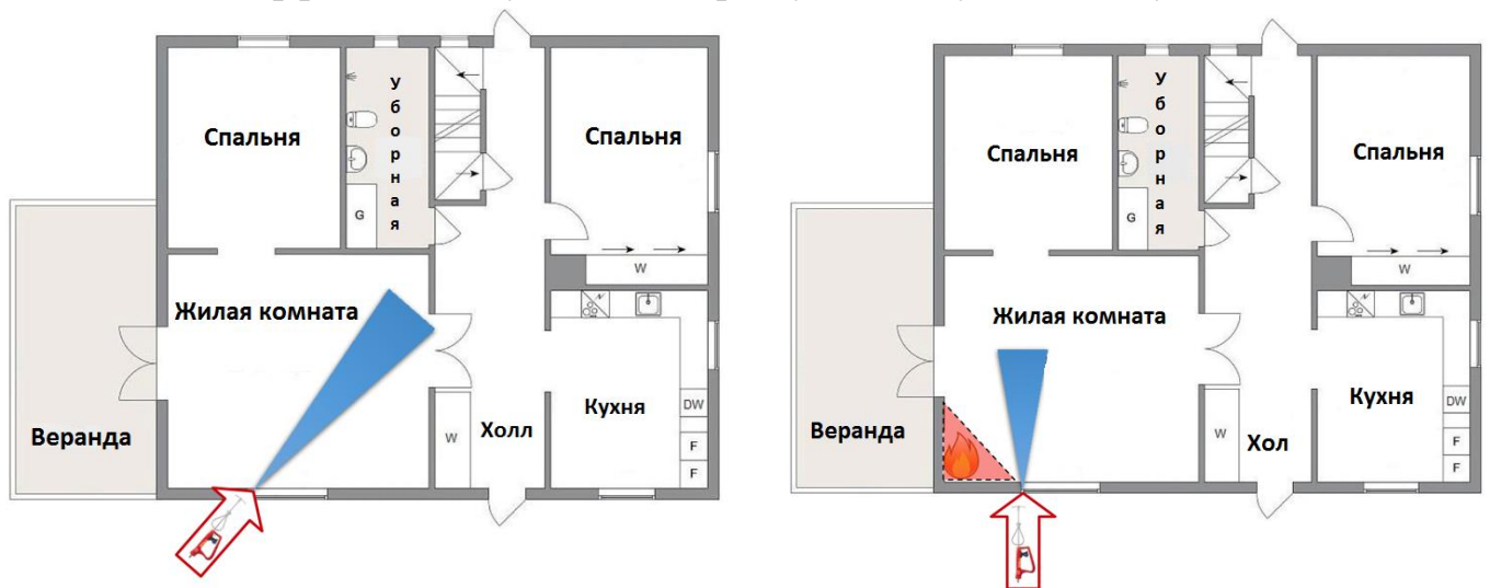
Рисунок 71. Подача ОТВ под различными углами
