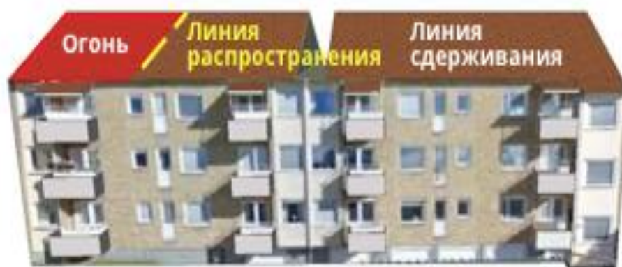
Рисунок 86. Противопожарный разрыв при тушении пожара в чердачном помещении
