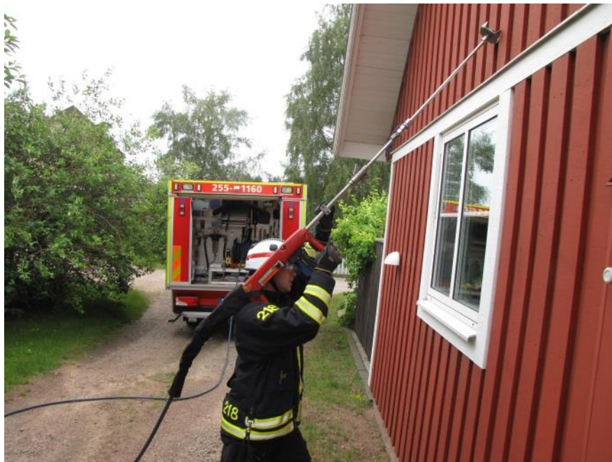
Рисунок 100. Применение удлиненного ствола установки при тушении
