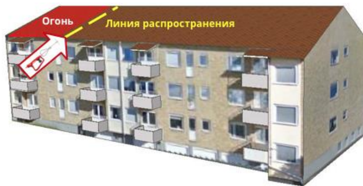
Рисунок 85. Подача ствола установки на линии распространения огня
