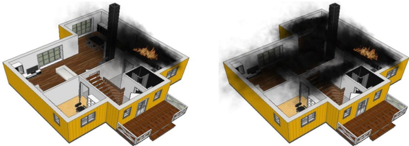
Рисунок 67. Распространение продуктов горения и пламени внутри здания
