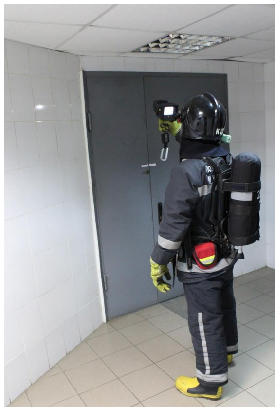
Рисунок 91. Определение скрытого горения при помощи тепловизора
