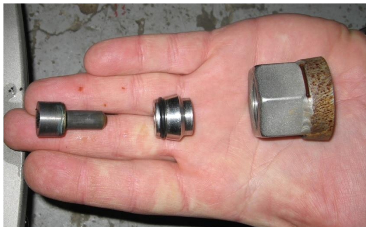
Рисунок 105. Разборка и прочистка распыляющей форсунки
