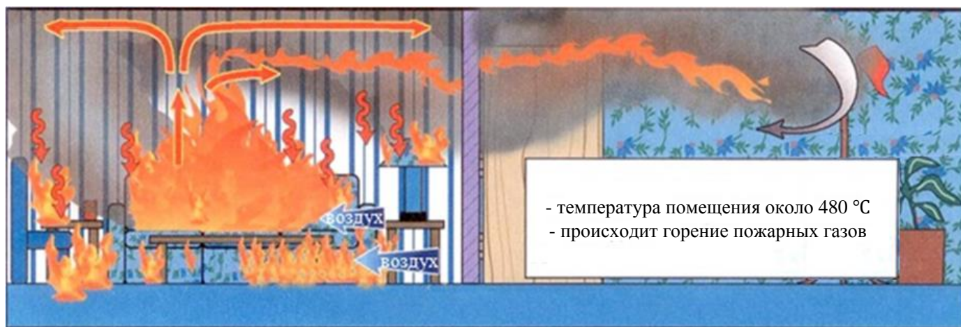
Рисунок 43. Горение пожарных газов
