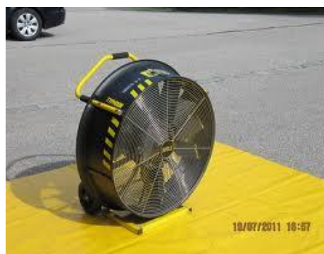
Рисунок 46. Вентиляторы с приводом от водяной турбины
