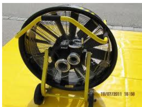
Рисунок 46. Вентиляторы с приводом от водяной турбины
