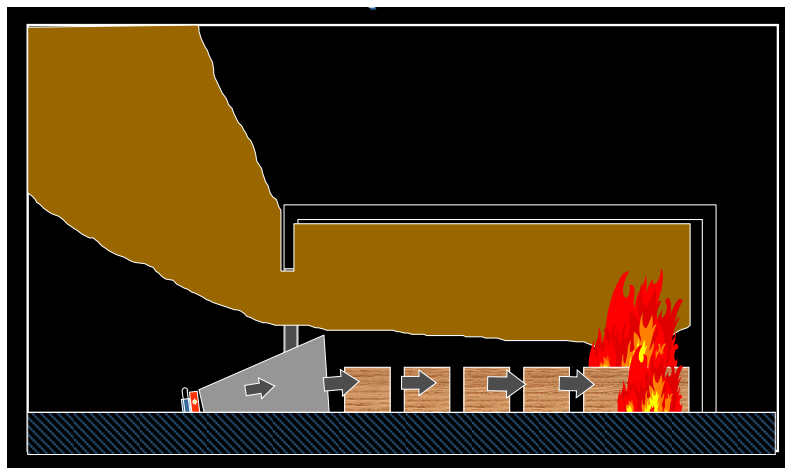
Рисунок 34. Схема организации вентиляции при отсутствии вытяжного проёма
