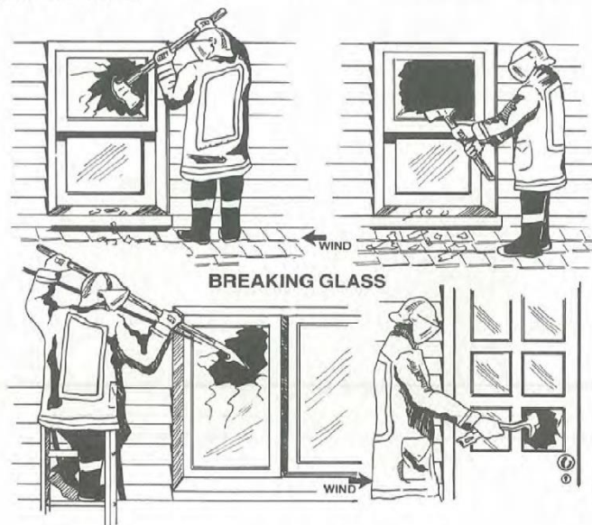
Рисунок 15. Способы разрушения остекления при нахождении с подветренной стороны
