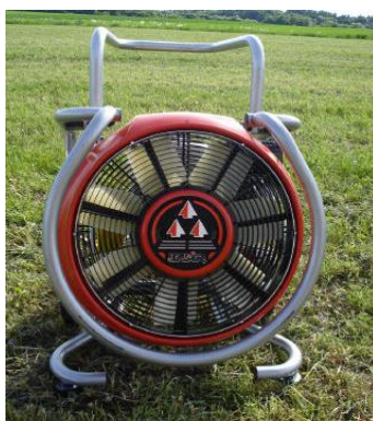
Рисунок 45. Вентиляторы с двигателем внутреннего сгорания
