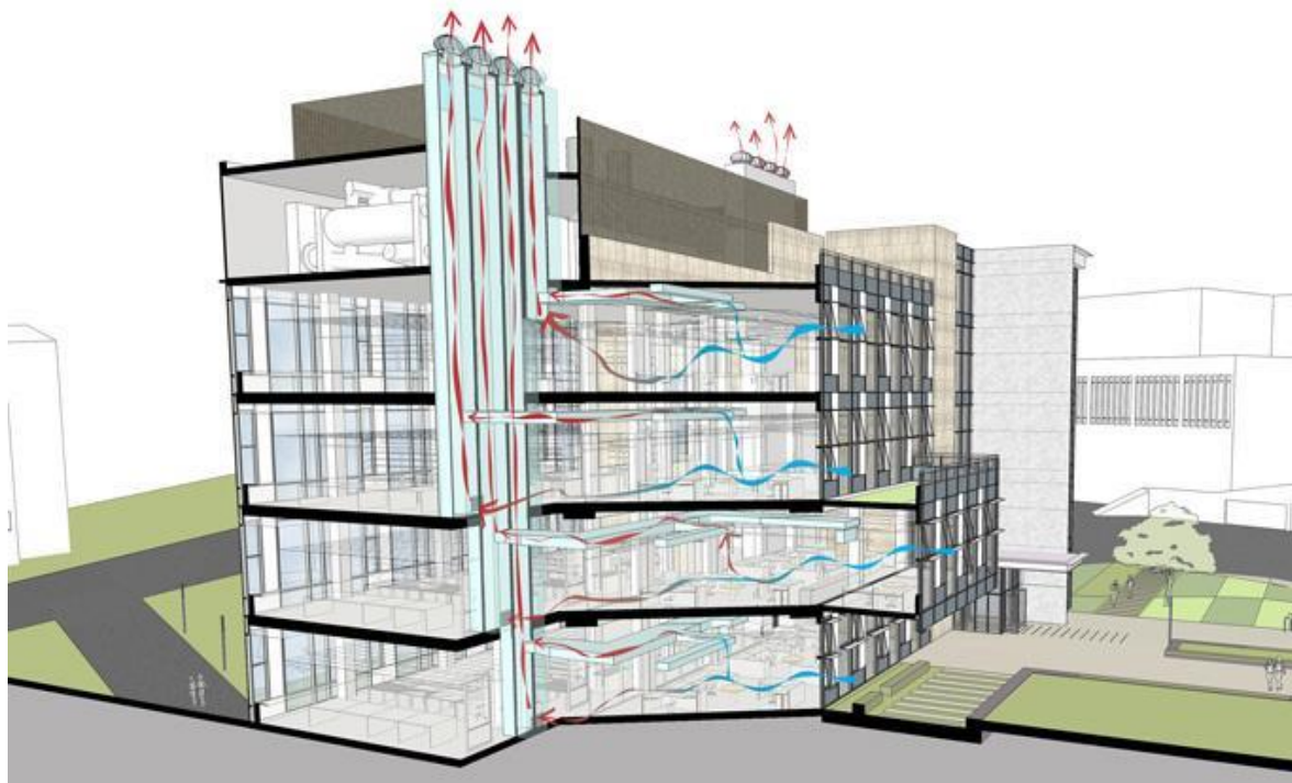
Рисунок 1. Движение воздуха при естественной вентиляции в здании
