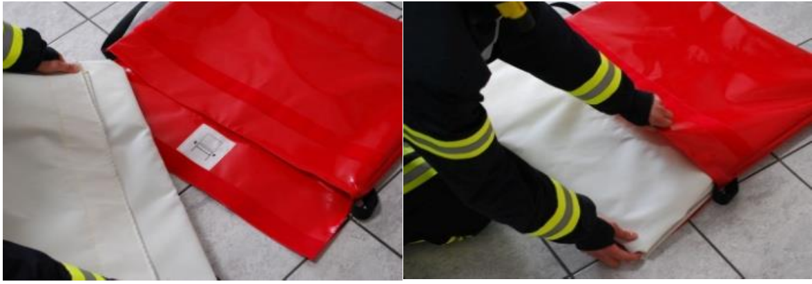
Рисунок 50. Укладка и упаковка занавеса
