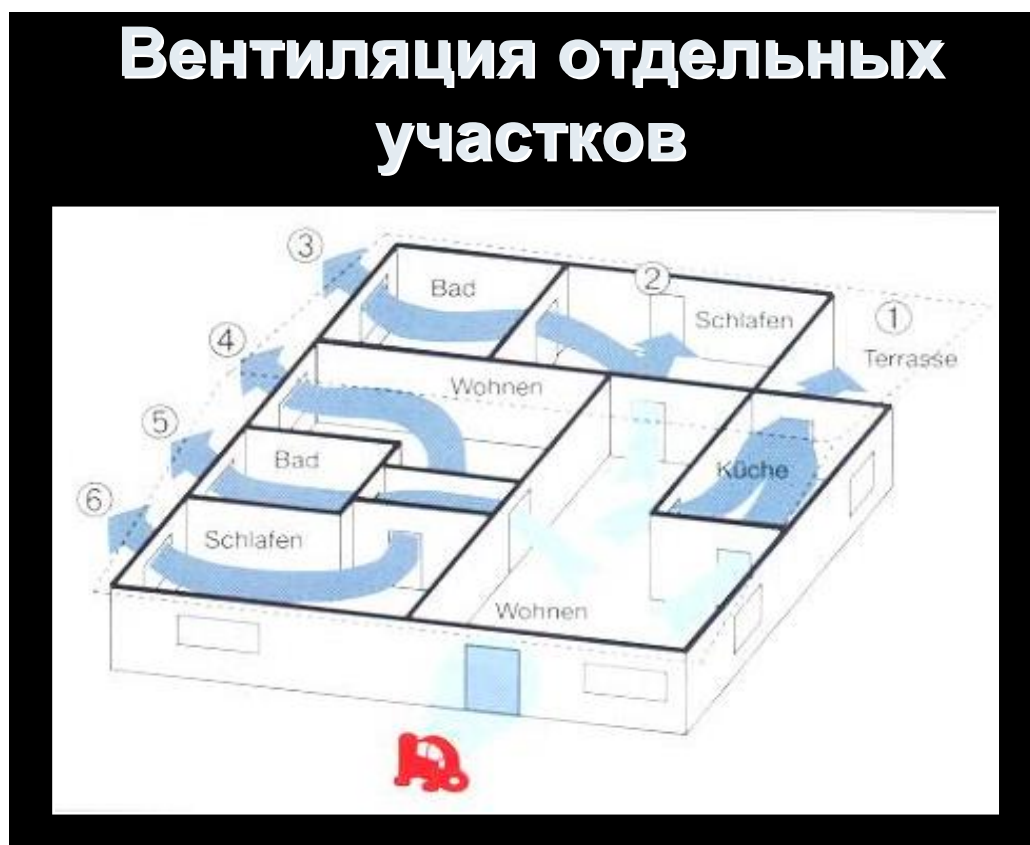
Рисунок 31. Манёвр воздушной струёй для вентиляции отдельных участков
