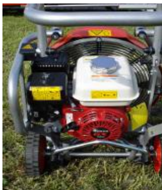
Рисунок 45. Вентиляторы с двигателем внутреннего сгорания
