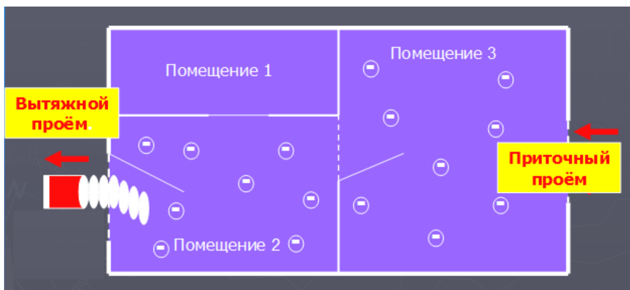
Рисунок 19. Организация вытяжной вентиляции методом разрежения
