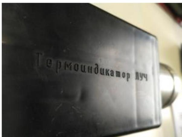
Прибор имеет «Г»-образную форму, материал корпуса – пластик, питание осуществляется от четырех элементов типоразмера «С», размещённых в рукояти. Также на рукояти размещена пластиковая антабка.
