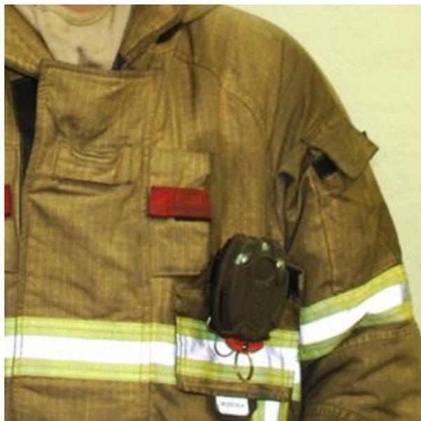
Наиболее оптимальным способом транспортировки датчика неподвижного состояния является переноска на защитной одежде в положении на груди. В том случае, если датчик транспортируется на подвесной системе СИЗОД, после завершения работ в непригодной для дыхания среде и дальнейшей работе без средств защиты пользователь обязан
